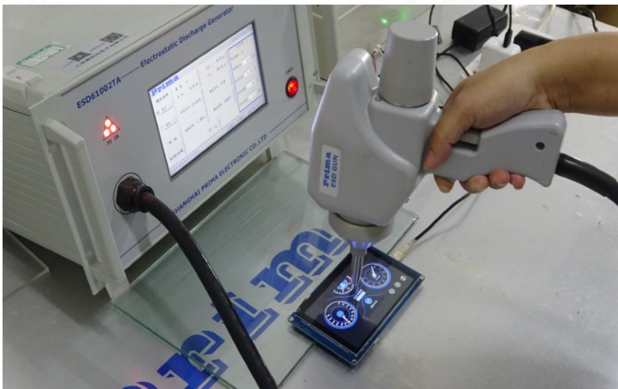
TJC8048X550_011R 静电放电测试图
